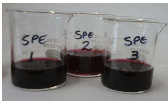
Figura 11. Extratos da polpa liofilizada de jambolão por CO 2 supercrítico com uso de H 2 O como cossolvente (Fonte: dados da pesquisa).
